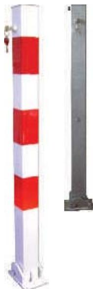
Absperrpfosten aus Quadratrohr, 70 x 70 mm, klappbar durch Zylinderschloß, mit Fußplatte 100 x 150 mm, zum Aufdübeln
